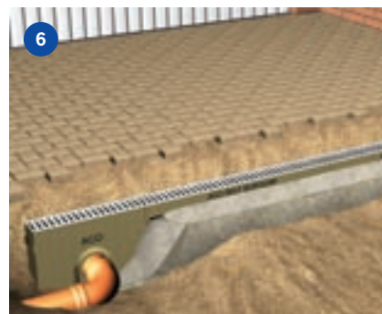
6 Utlopp med sandfång: Sandfång rekommenderas vid anslutning till dagvattenledning. På så sätt är risken liten att rören fylls med löv och grus. Markränna kan anslutas till båda sidor med fall mot Sandfånget. Anslut avloppsroret med stös till sidan av Sandfånget. OBS! Vagg vid anslutning av markränna slås försiktigt ut inifrån Sandfånget.
