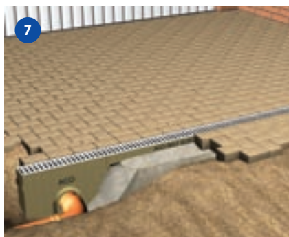
7 Till slut läggs grus, den omgivande beläggnings och spaltgallerna på plats. Ev. limning eller tätning av skarvar görs med tvåkomponentslim eller ACO Water Seal tätningssmassa. Tätning av större skarvar görs med polymerspäckel eller Plastic Padding (PP100).
